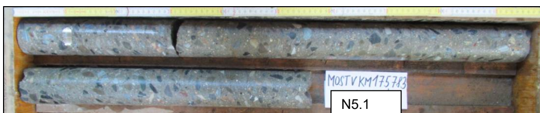
Obr. č. 12- diagnostický návrť N5.1 do levého sloupu pilíře 1
