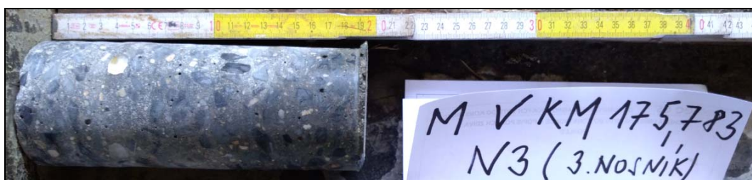
Obr. č. 9 - diagnostický návrť N3.1 do nosné konstrukce nosníku v 3. poli
