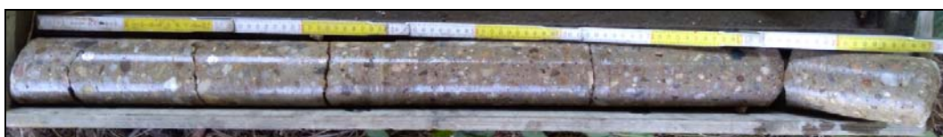
Obr. č. 8 - diagnostický návrť N2.2 do nosné konstrukce desky v 2. poli
