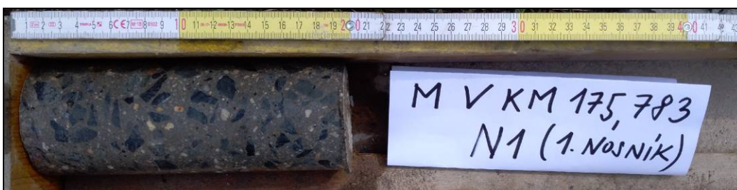
Obr. č. 5 - diagnostický návrť N1.1 do nosné konstrukce nosníku v 1. poli
