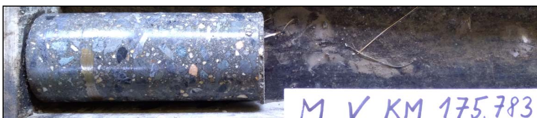
Obr. č. 7 - diagnostický návrť N2.1 do nosné konstrukce nosníku v 2. poli
