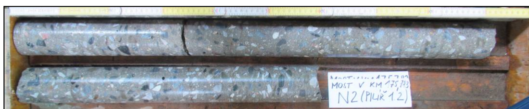
Obr. č. 13 - diagnostický návrť N5.2 do pravého sloupu pilíře 1
